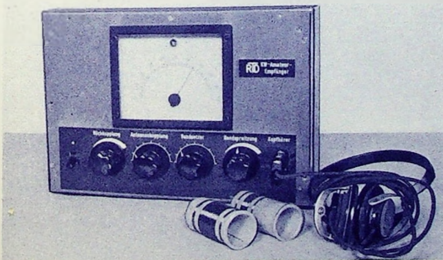
Bild 2. Die übersichtliche Anordnung der Bedienelemente kommt den Betriebsbedingungen für den Amateurlenk entgegen. Links befinden sich Netzschalter und Rückkopplungsregler, an die sich Antennenkopplung, Bandsetzer und Bandspreizer anschließen, während rechts das Buchsenpaar für den Lautsprecher angeordnet ist. Anschlüsse für Antenne und Erde sowie Lautsprecher liegen auf der Rückseite. Die Skala hat Gradenteilung und eine Skalenlampe zur Betriebsanzeige
