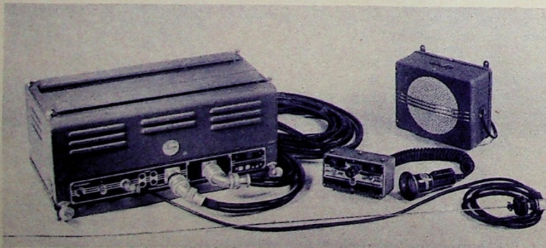
Bild 2. Komplette Mobilofon-Anlage mit Bedienungskästchen, Handmikrofon usw.
