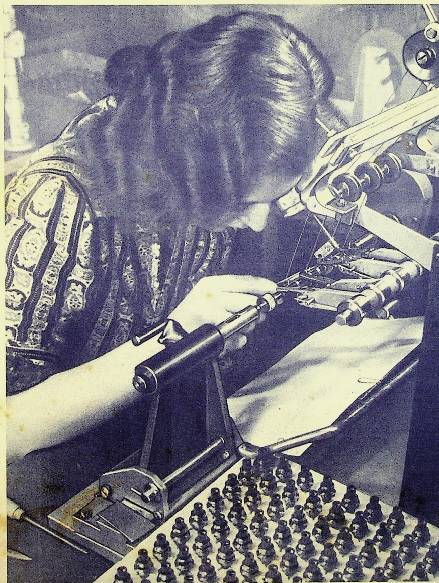
Das Berliner Gerätewerk der Philips Valvo Werke stellt jetzt auf modernisierter Grundlage den Superhetempfänger „Merkur“ mit einer Auflage von 10 000 Stück her. Auf neuen Wickelmaschinen können für das Gerät gleichzeitig vier HF-Spulen gewickelt werden.
